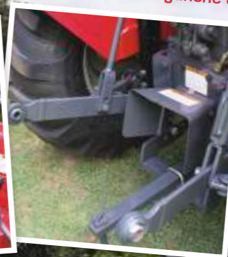
Elevación de 1,6 toneladas en el punto de enganche 3
